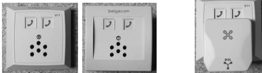
Le modem VDSL doit être connecté au port RJ11 du filtre enfichable ou de la fiche VoIP à l'aide d'un cordon de brassage approprié.
